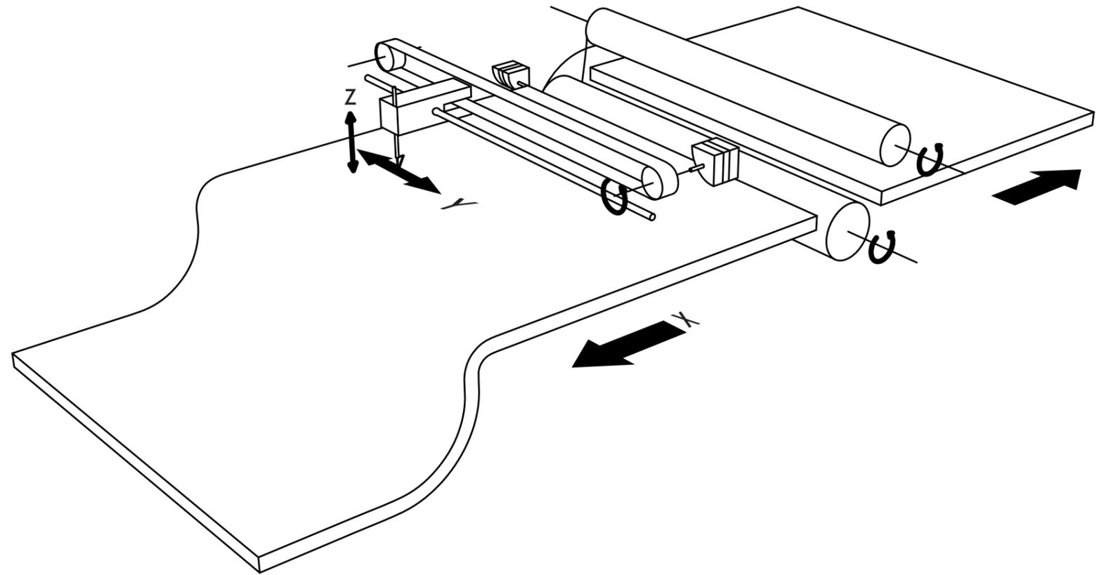
Fonctionnement de la machine de découpe : à partir d'une imprimante A3 et d'une tête de découpe.
